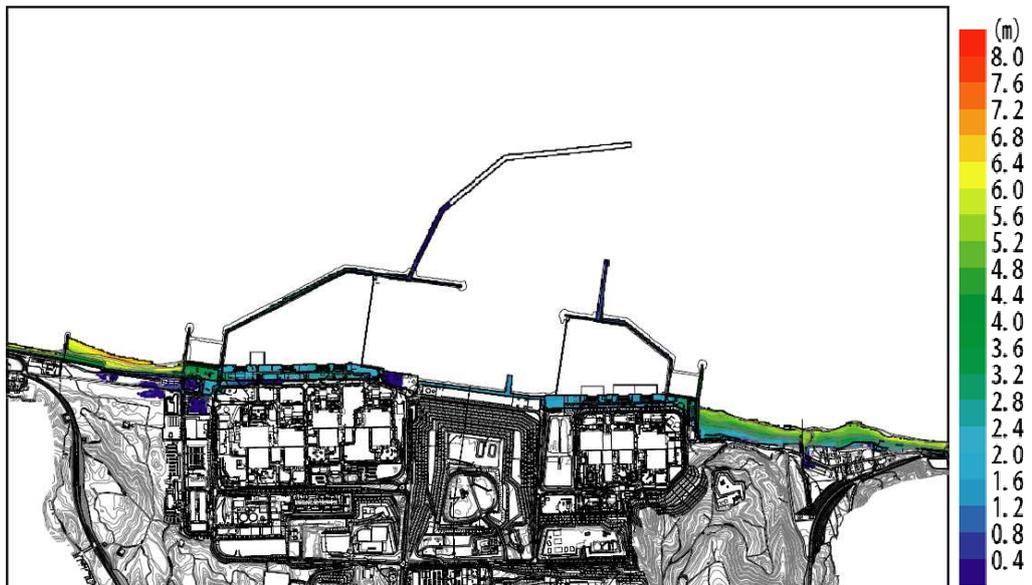
第 2.2-2 図 基準津波（基準津波 3）の遡上波による最大浸水深分布
