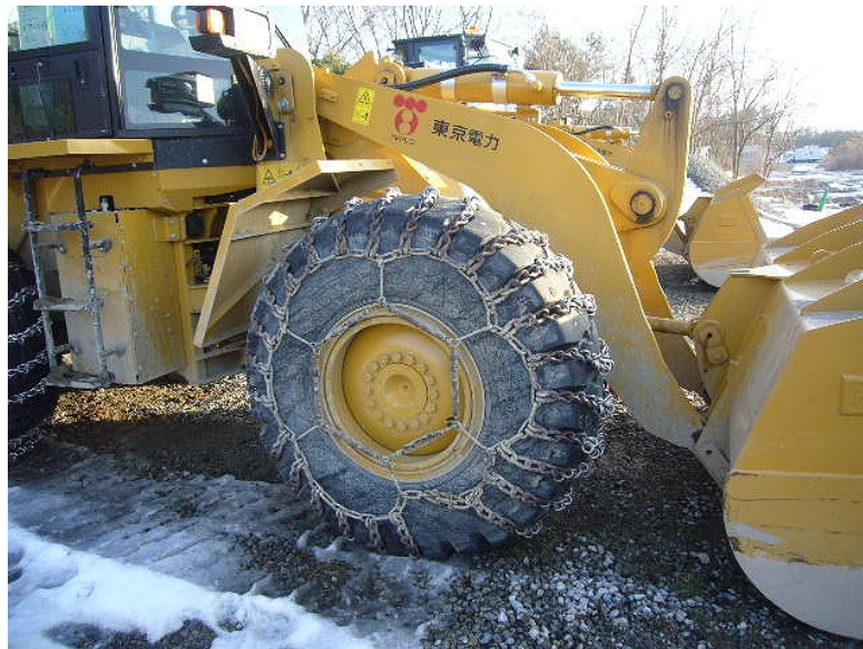
重機の凍結路面の滑り防止対策
