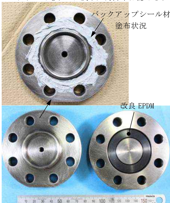
図 11 試験体の状況 (改良 EPDM+バックアップシール材)
