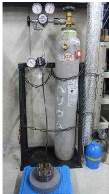
図 12 He 気密確認試験状況
