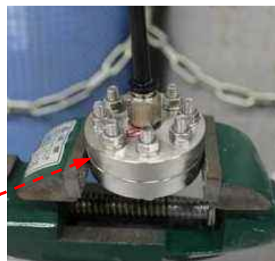
図4 気密確認試験状況
