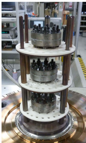
図3 蒸気暴露試験片設置状況
