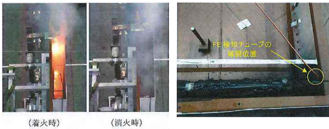
図 9：試験 V1 における発火・消火時の状態
