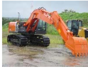
③-32 建設重機 (バックホー)
