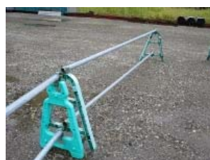
④-41 鋼製車止め (単管バリケード)
