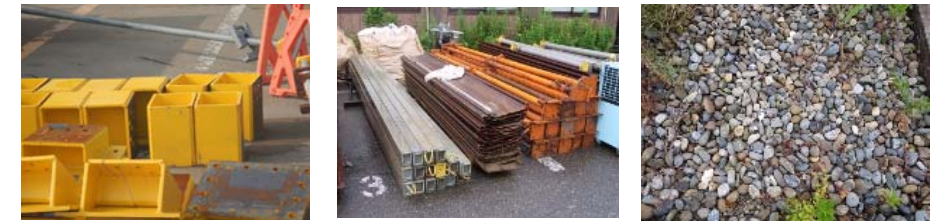
鋼製材（最大飛散高さ 0.08m） 角型鋼管（大）（最大飛散高さ 0.15m） 砂利（最大飛散高さ 0.08m）
