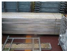
③-41 仮設足場板
