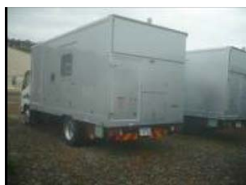
②-10 可搬型代替交流電源設備 (電源車)
