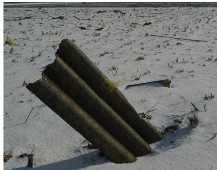
周囲の田に散乱した屋根ふき材
