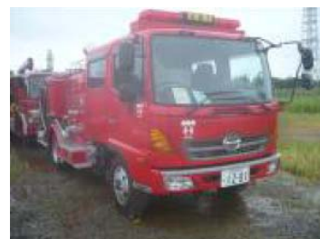
②-9 可搬型代替注水ポンプ (消防車)
