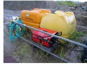
③-18 高圧洗浄機, 水タンク
