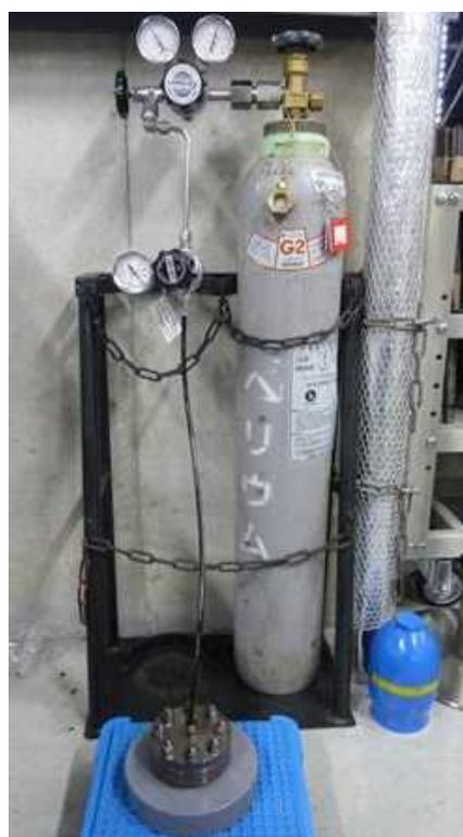
図 12 He 気密確認試験状況
