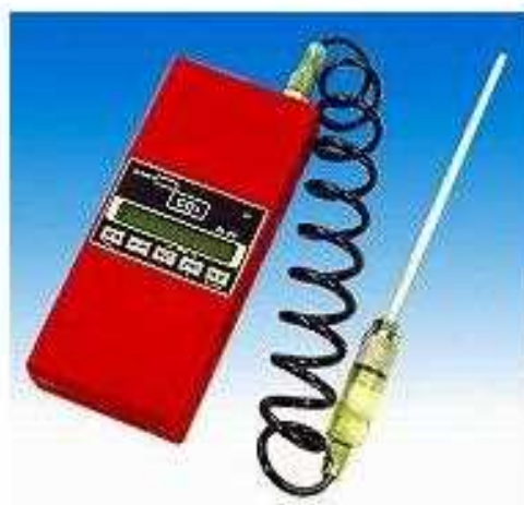
図 61-5-14 二酸化炭素濃度計の概略図
