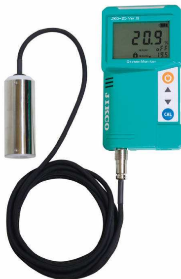
図 61-5-13 酸素濃度計の概略図
