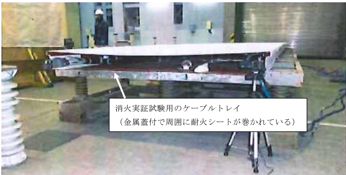
図 3 : 消火実証試験用のケーブルトレイ外観
