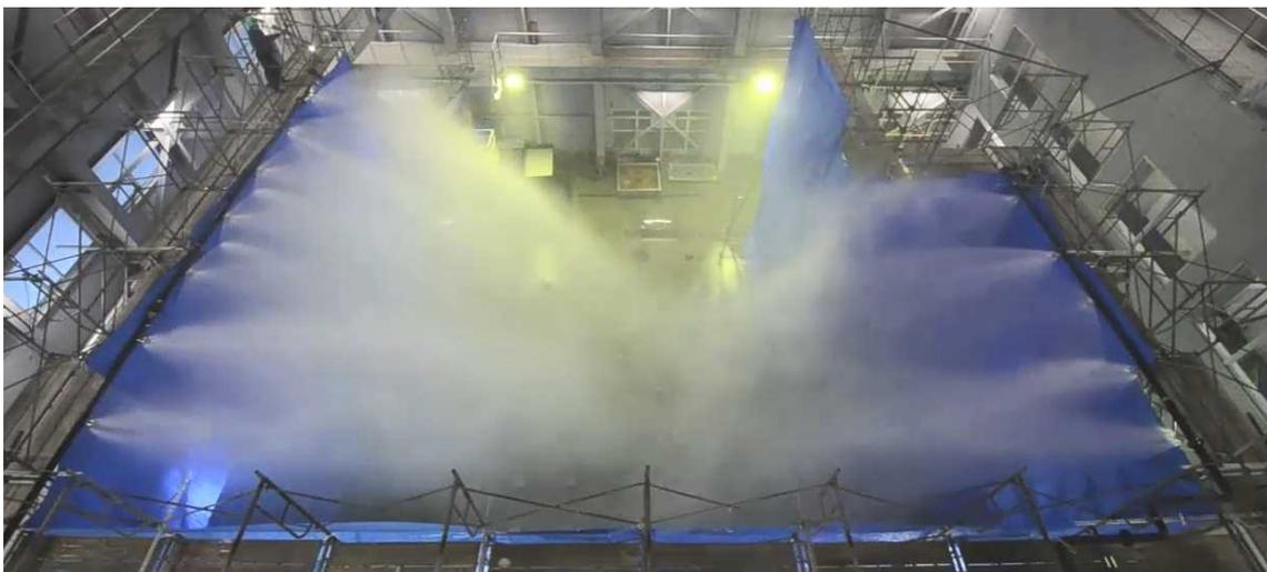
図6 スプレー状態の試験状況（スプレー量：132m<sup>3</sup>/h）
