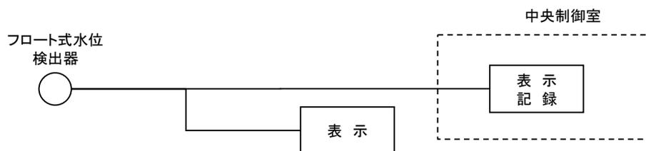
図 50-3-14 ドレンタンク水位の概略構成図
