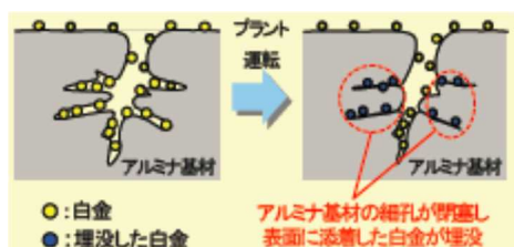
図(添付1-2) ベーマイトが多い触媒における白金の活性表面積の減少イメージ
