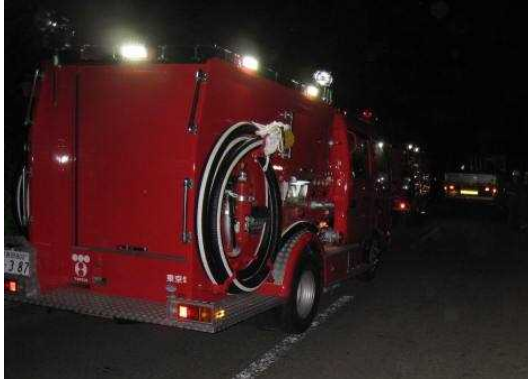
車両の作業用照明
