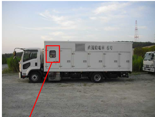
直流給電車操作部
