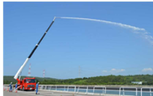
高所放水車による放水状況
