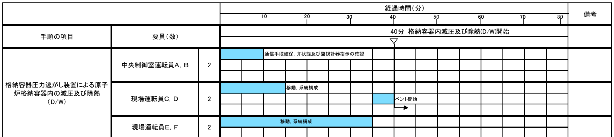
図 1.5.33 格納容器圧力逃がし装置による原子炉格納容器内の減圧及び除熱 (D/W) タイムチャート (現場操作による格納容器ベント)
