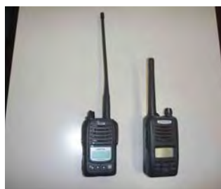
無線連絡設備 (可搬型)
