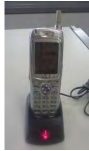
電力保安通信用電話設備 (PHS 端末)
