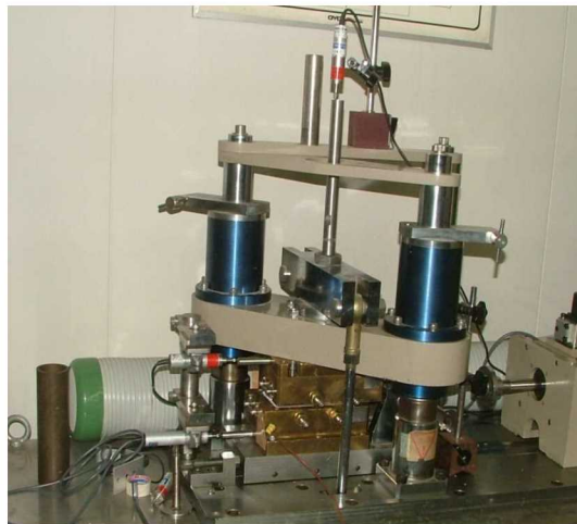
図 2-2 試験装置（高速載荷・繰返し載荷試験）
