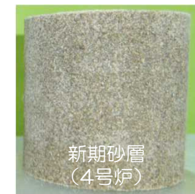
図 試験供試体例 (左上：洪積砂層 I 右上：洪積砂層 II 下：新期砂層)
