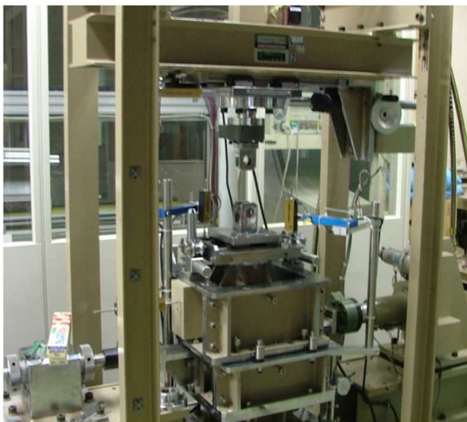
要素試験 (地中外壁摩擦試験)
