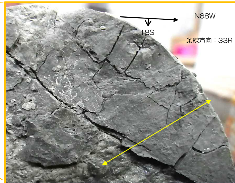
F5-17孔 F 5 断層の最新面近接 条線③ (下盤側から) F 5 断層の走向・傾斜 N68W18S
