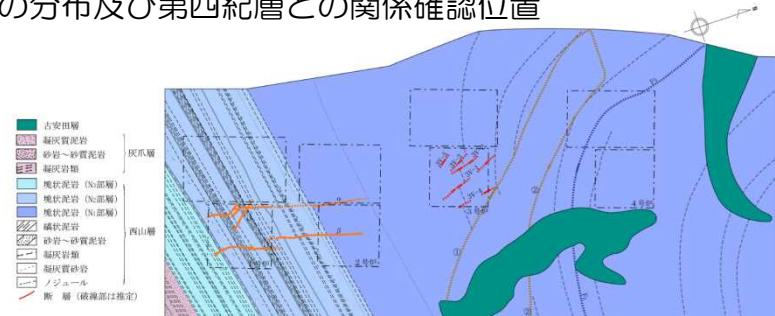
荒浜側地質水平断面図（標高-39m）
