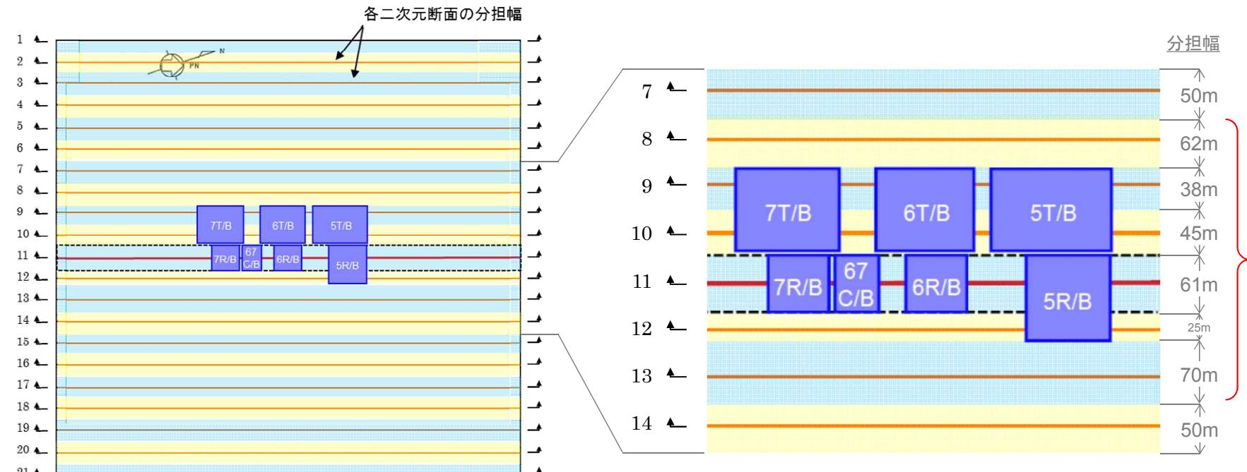
各二次元断面の分担幅図
