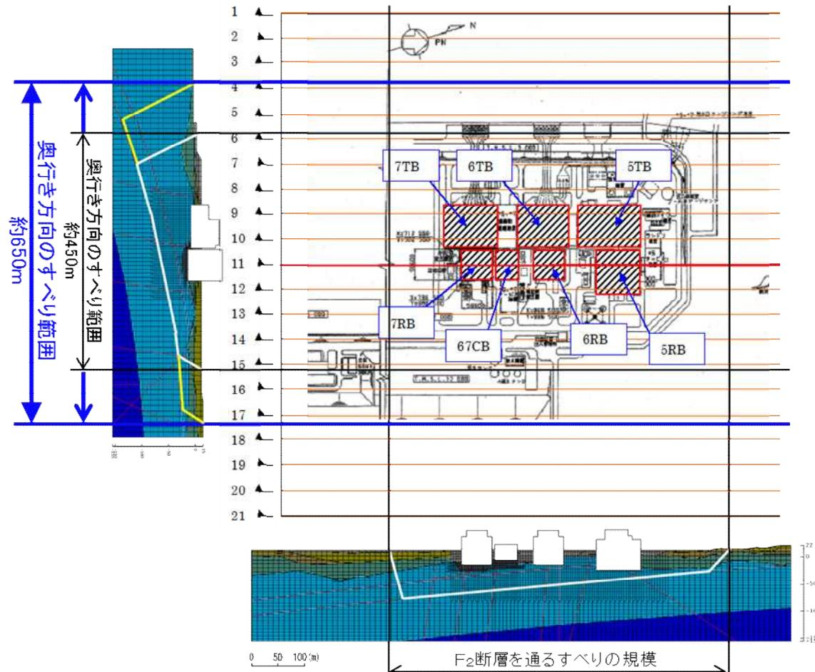
6, 7号炉原子炉建屋 汀線平行断面
