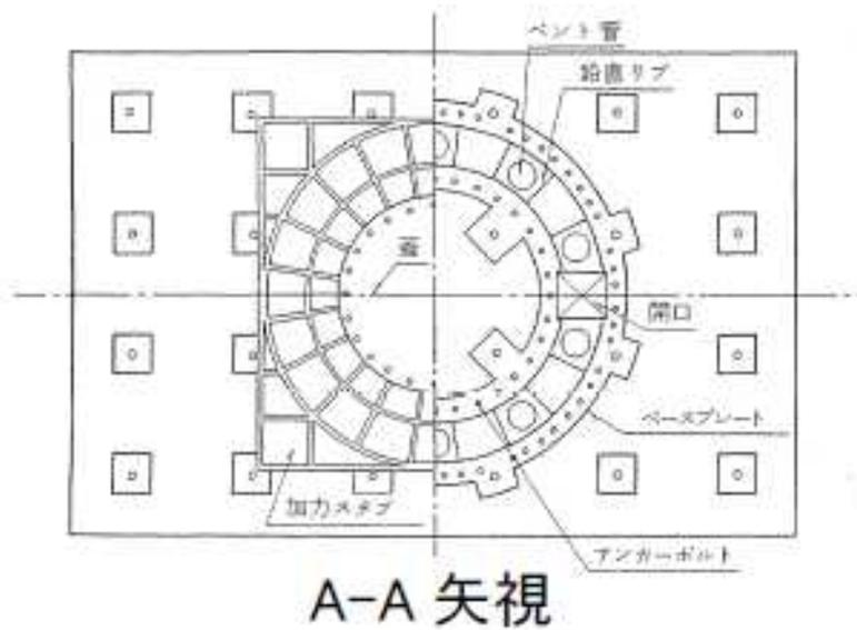
図 2-1 RPV ペダスタルの試験体と加力装置の概要
