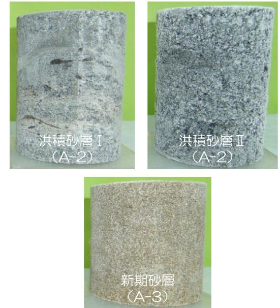
図 試験供試体例 (左上: 洪積砂層 I
