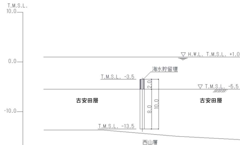
6号炉海水貯留堰断面図 (単位：m)
