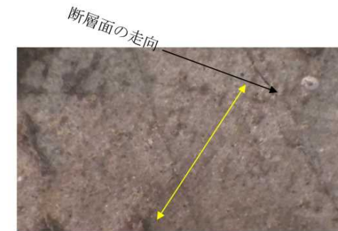
\alpha 断層 ( \alpha 2 ) の条線 (黄色矢印方向)
