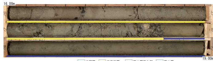
古安田層／西山層境界付近のコア写真 沖積層 古安田層 西山層風化部 西山層
