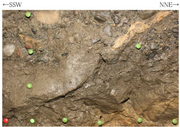
拡大写真C F 5 断層先端部 (西山層オーバーハング部) 緑のピンの間隔は10cm
