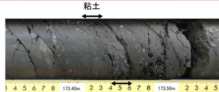
F<sub>5</sub>断層のコア写真（F5-9孔標高-168m（深度173m）付近）
