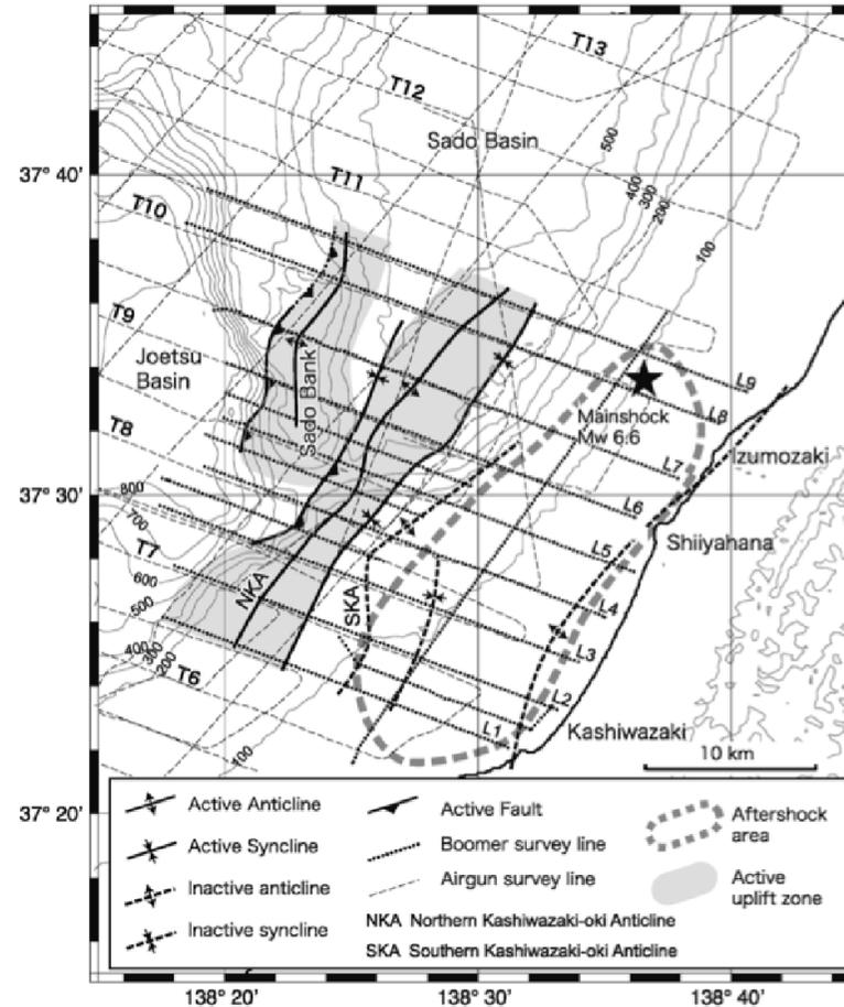
第3図 2007年中越沖地震後の高分解能マルチチャンネル音波探査に基づいた震源域の地質構造図。
