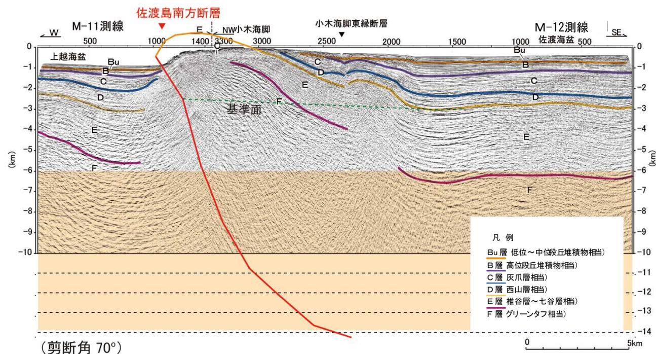
(剪断角 70°) バランス断面法により推定される地下深部の断層面 (佐渡島南方断層: M-11測線・M-12測線)
