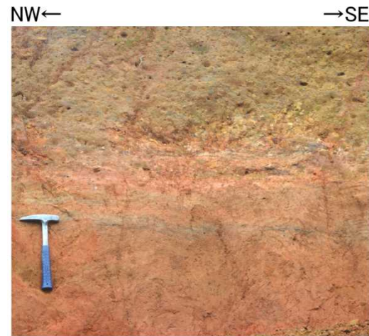
露頭写真 (Loc. a, 柏崎市細越北方) Loc.a (反転) 礫・シルト互層, 12° SW傾斜を示す。
