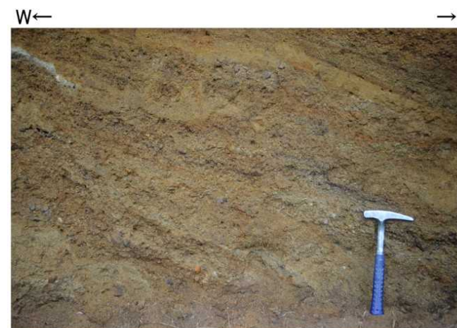
Loc.3 露頭写真 (Loc. 3, 柏崎市加納) 魚沼層砂岩・礫岩互層, 層理面の走向・ 傾斜は N26^{\circ}E, 24^{\circ}E 。
