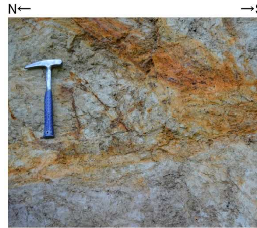
露頭写真 (Loc. d, 柏崎市細越北東) Loc.d (反転) シルト, 13° SW傾斜を示す。
