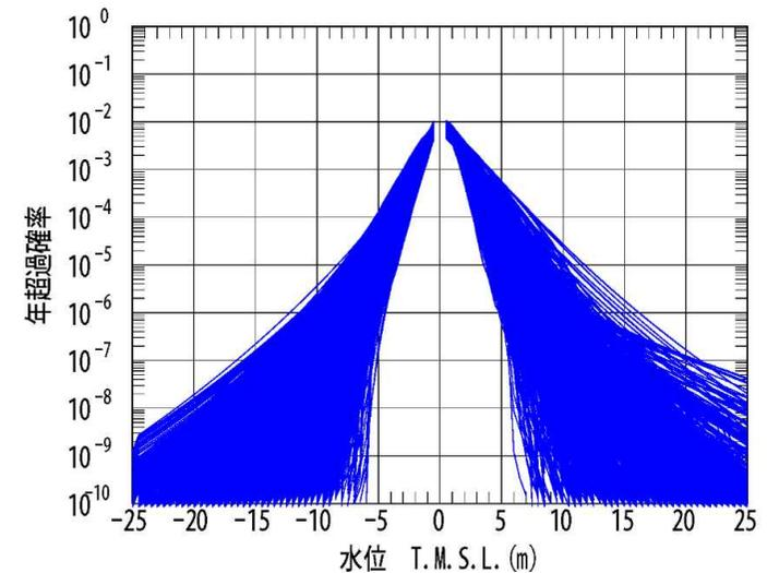
2,000本のハザード曲線（1号炉取水口前面）
