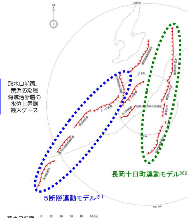
取水口前面, 荒浜防潮堤 海域活断層の 水位上昇側 最大ケース
