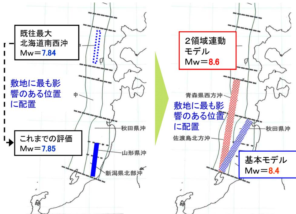
既往最大規模の波源を地震調査研究推進本部(2003)が設定している地震の発生領域に配置
