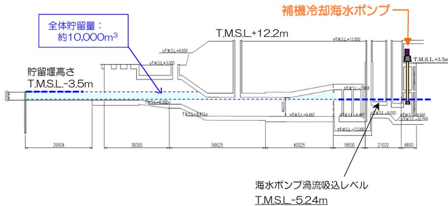
6号炉取水路 A-A'断面図
