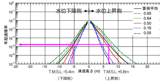
フラクティルハザード曲線(1号炉取水口前面)
