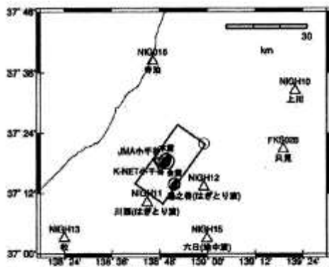
図1 探索範囲とする断層面(矩形)と、本震と余震の震央位置・メカニズム解(F-net)、インバージョンに用いた観測点(△)位置。
