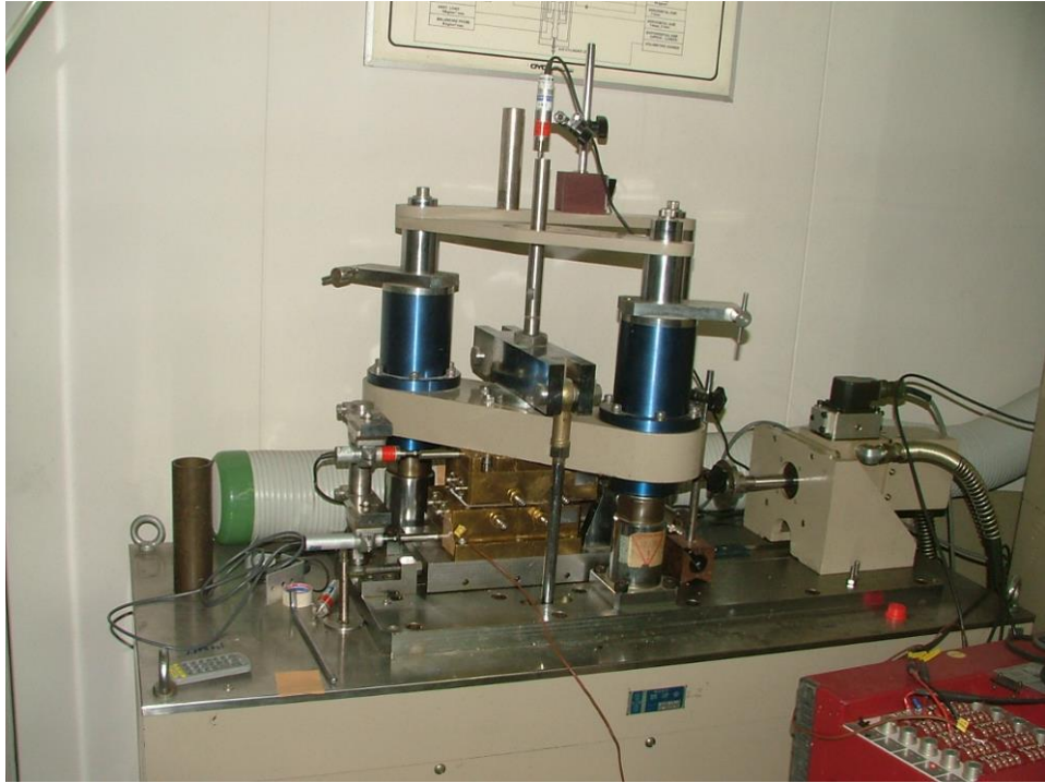
写真-2.3.1 一面せん断試験装置全景
