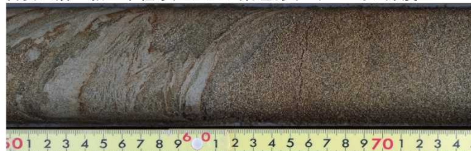
古安田層：細～中粒砂，シルト葉理あり (V1-1 孔 深度 34.60m 付近)
