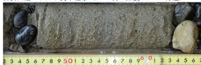
古安田層：細～中粒砂，シルト葉理あり (V1-1 孔 深度 34.60m 付近)
