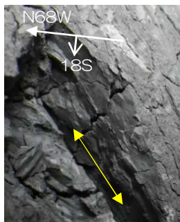
条線方向: 54R N68W 18S F5-17条線② (上盤側から)
