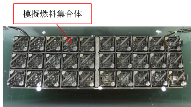
(2) 供試体の水槽内設置状況
