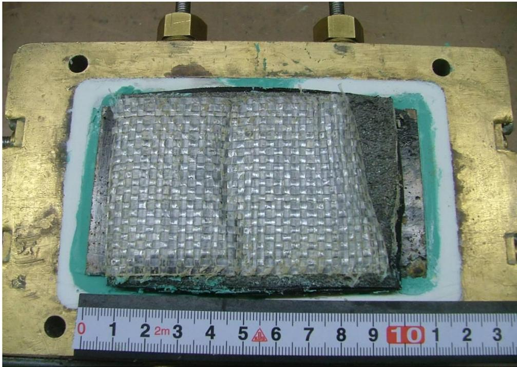
写真 3.3.7 一方向載荷試験後の供試体状況
