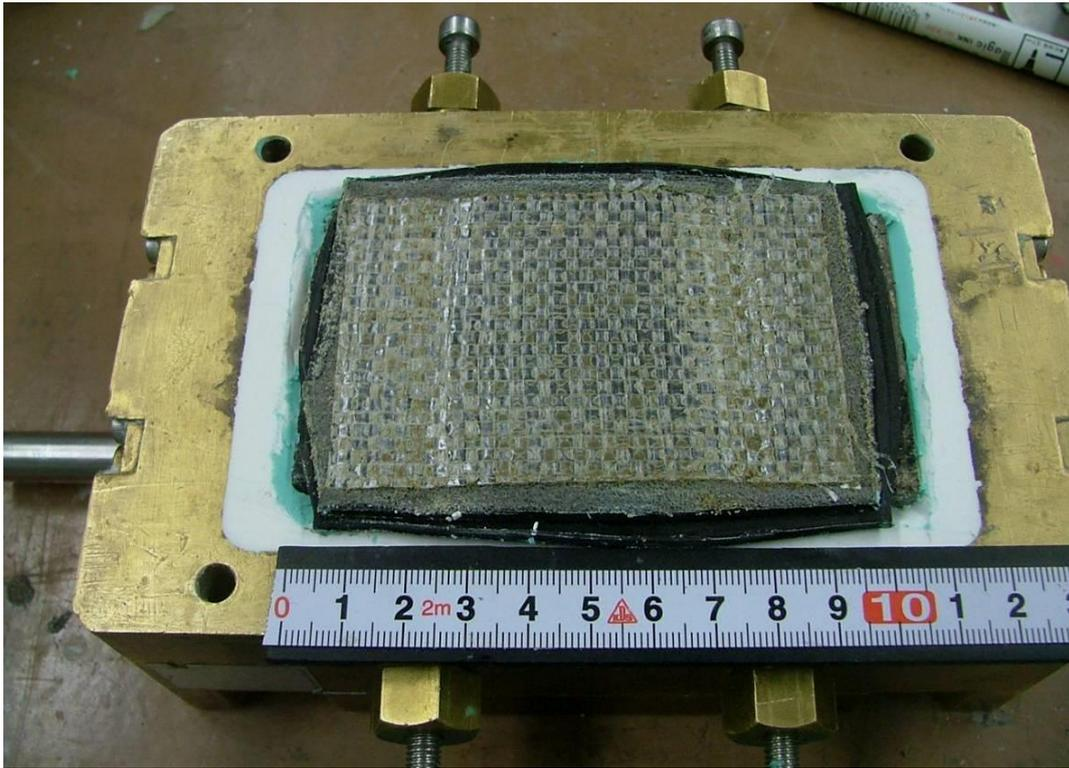
写真 3.3.15 繰返し载荷試験後の供試体状況 ケース 1-8 (保護層表面)
