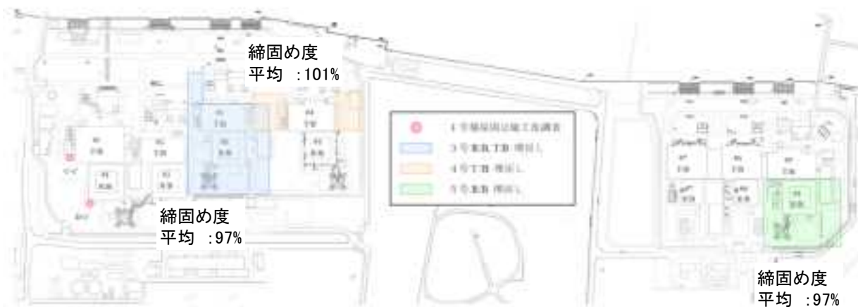
埋戻土の締固め度 (建屋周辺)
