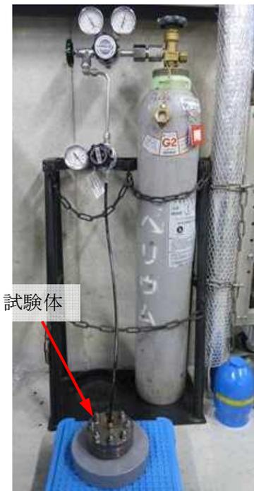
図5 He気密確認試験状況
