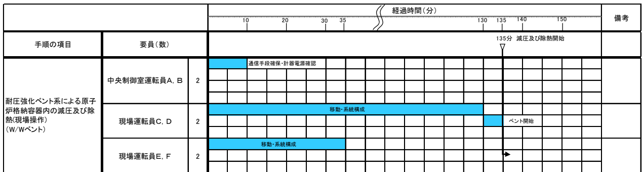
図 3.5-6 耐圧強化ベント系による除熱 (W/W ベント) のタイムチャート*
