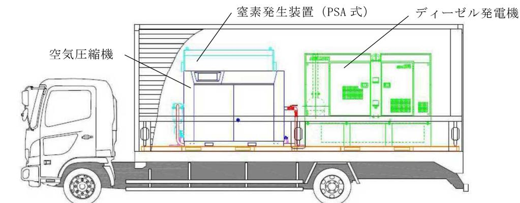
第 2.3.5.2-7 図 可搬式窒素発生装置車載図
