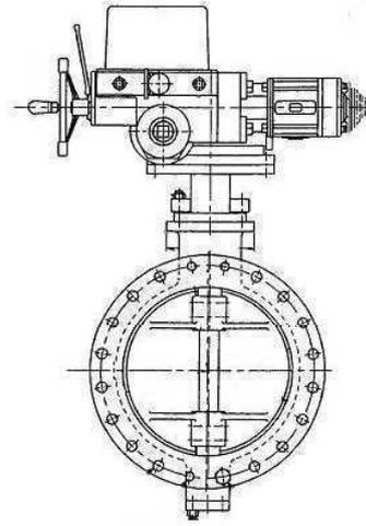
第 2.2.2.2-2 図 電動駆動弁
