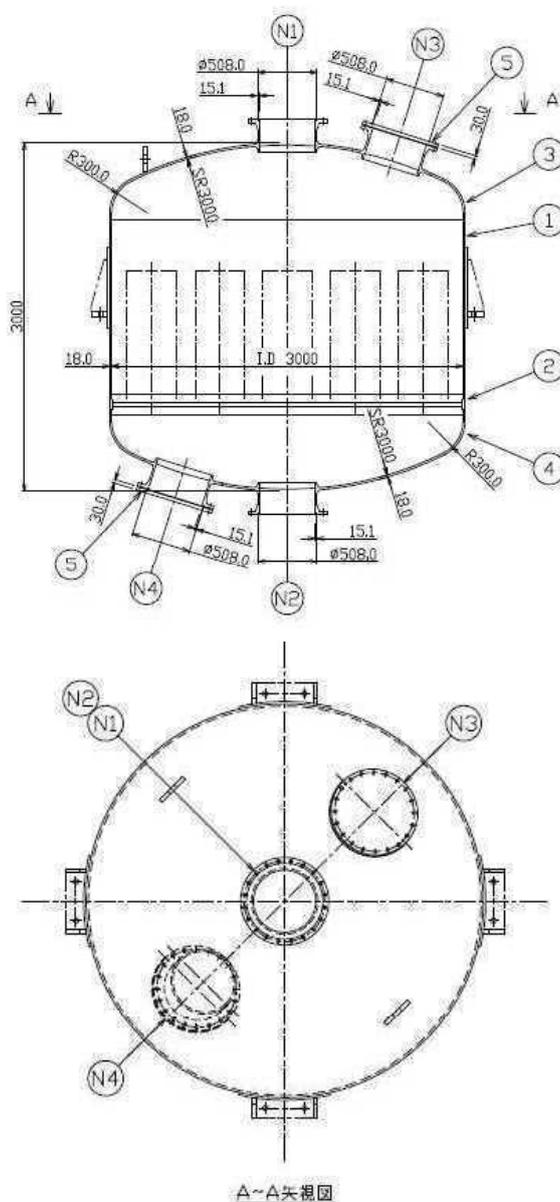
第 2.2.1-5 図 よう素フィルタ構造図 (容器)
