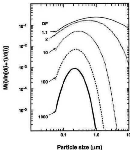
第 3.2.2.1.1-10 図 ドライウェルスプレイを実施し続けることによる格納容器内の粒径分布の変化 (図中の値はドライウェルスプレイによる積算の除去効果)
