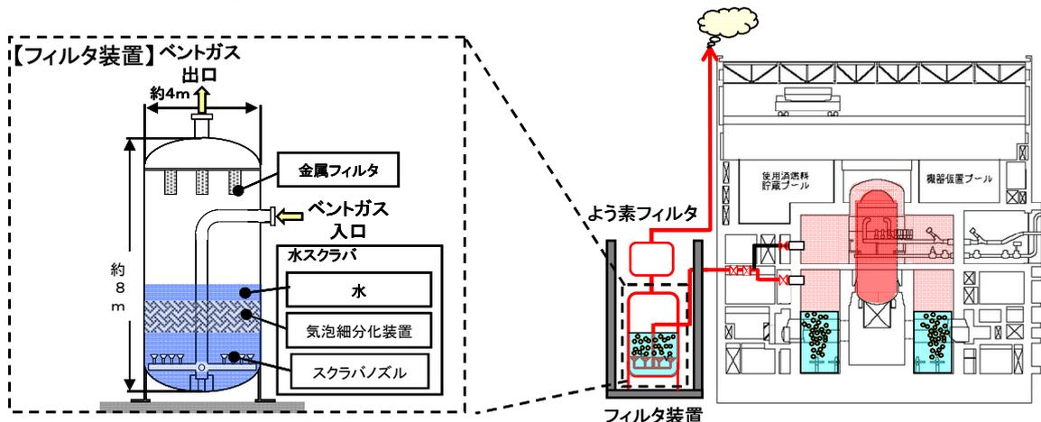
第 1.1-1 図 格納容器圧力逃がし装置及び代替格納容器圧力逃がし装置
