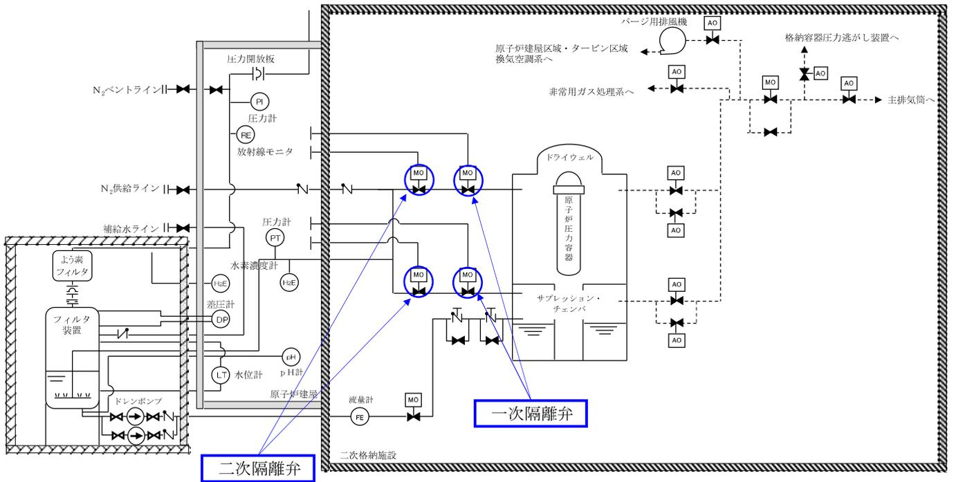
第 1.2.2-2 図 代替格納容器圧力逃がし装置系統概要図
