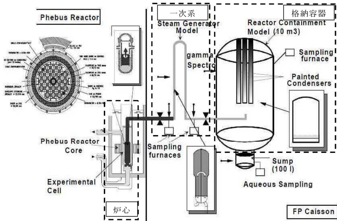
第 3.2.2.1.1-13 図 試験装置の概要
