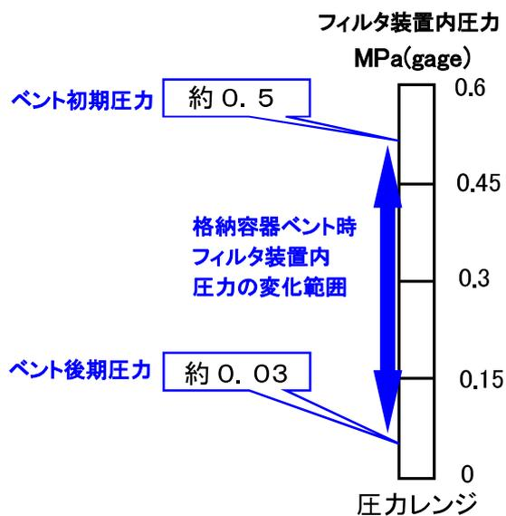
第 3.2.2.2-7 図 フィルタ装置内圧力の評価結果
