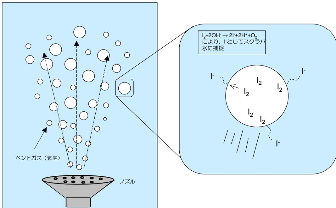
第 3.1.2.1-1 図 水スクラバによる無機よう素除去原理（イメージ）
