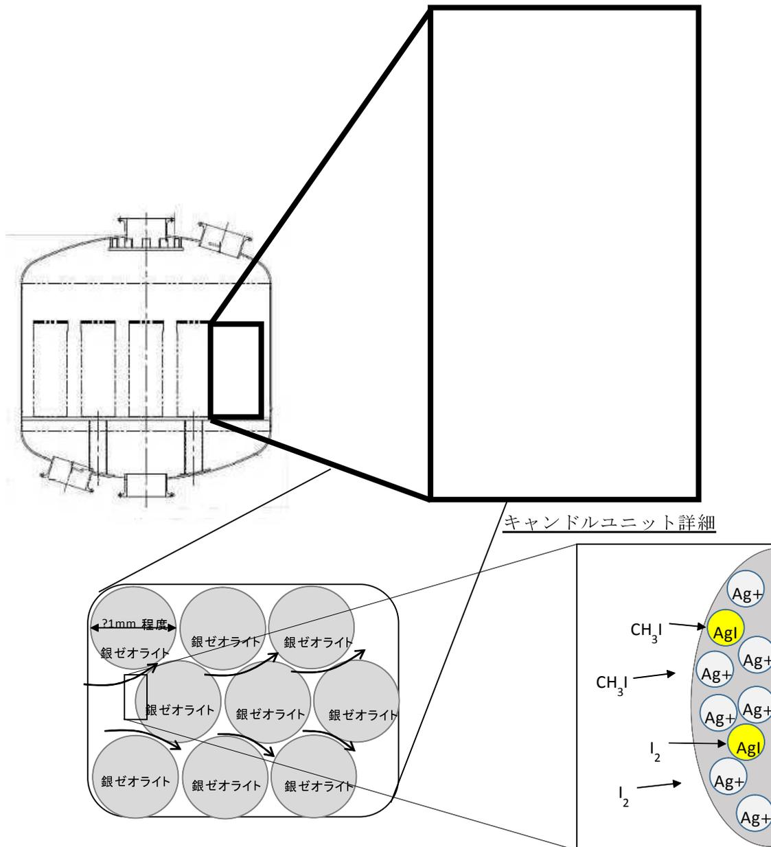
第 3.1.2.2-2 図 吸着材によるよう素除去原理 (イメージ)
