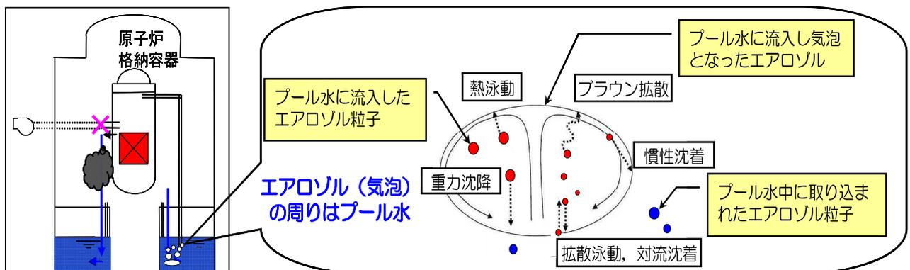
第 3.2.2.1.1-5 図 粒子径分布の評価モデル
