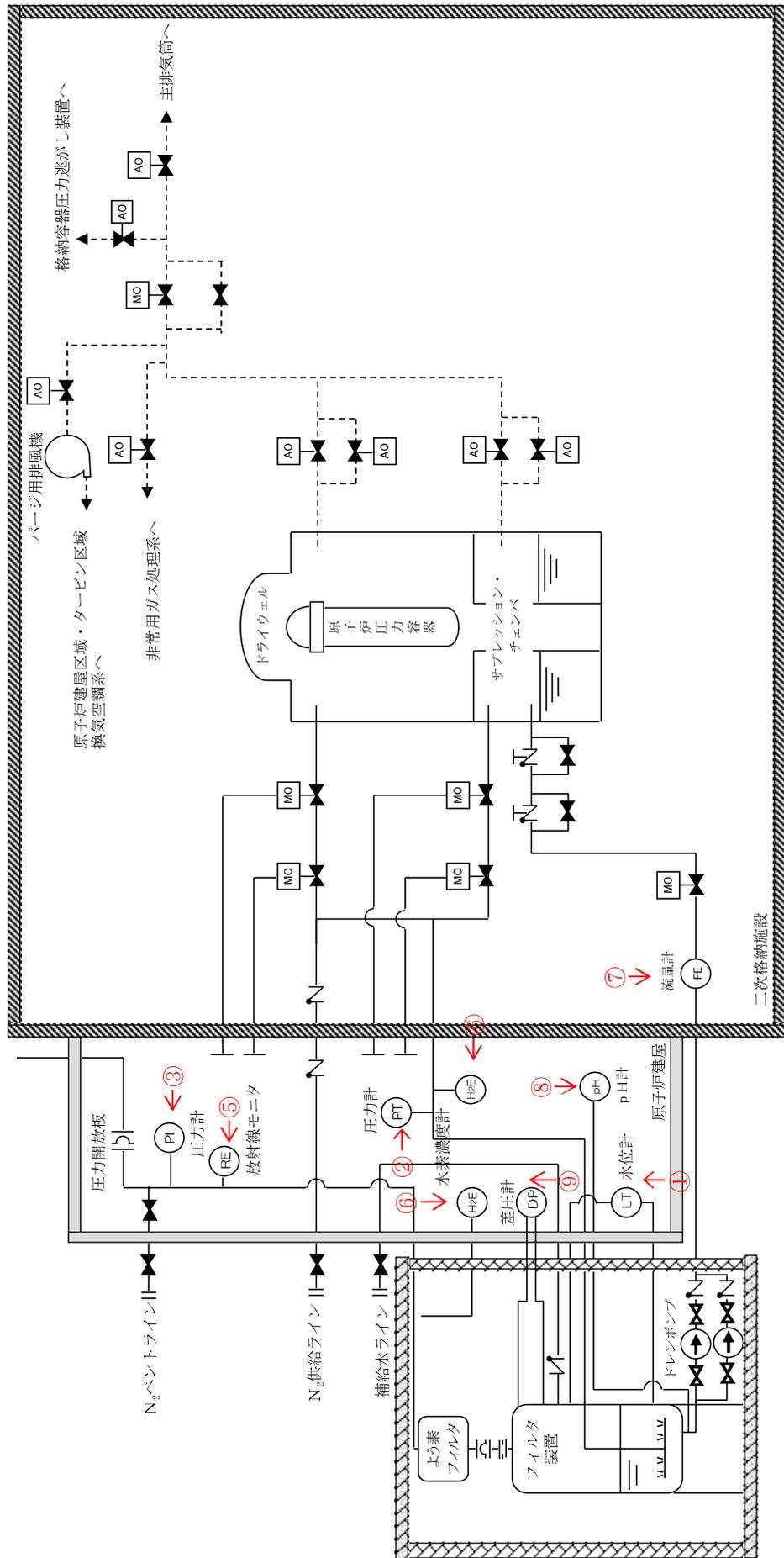
第 2.3.2.3-2 図 代替格納容器圧力逃がし装置の計測設備 概略構成図
