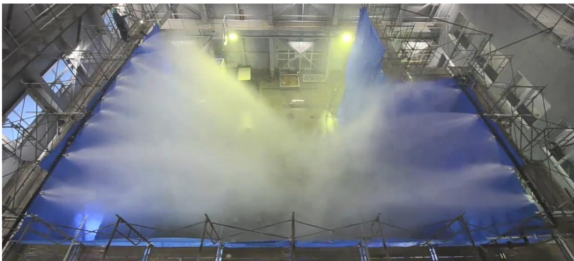
図6 スプレー状態の試験状況（スプレー量：132m 3 /h）
