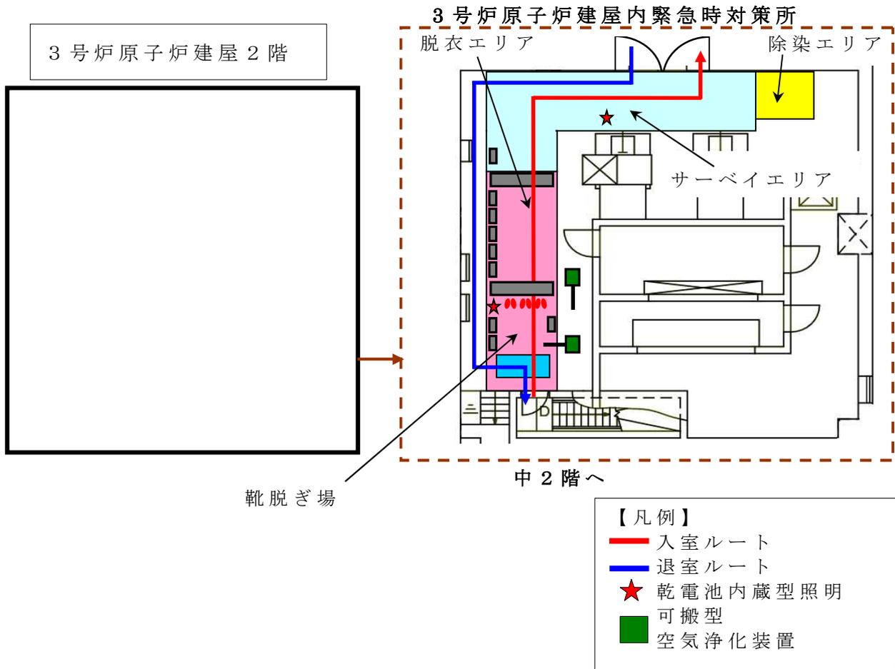
図 3.3-2 3号炉原子炉建屋内緊急時対策所チェンジングエリア
