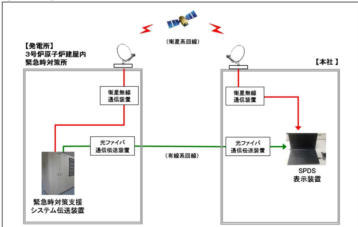
図 62-5-20 データ伝送設備 試験・検査構成
