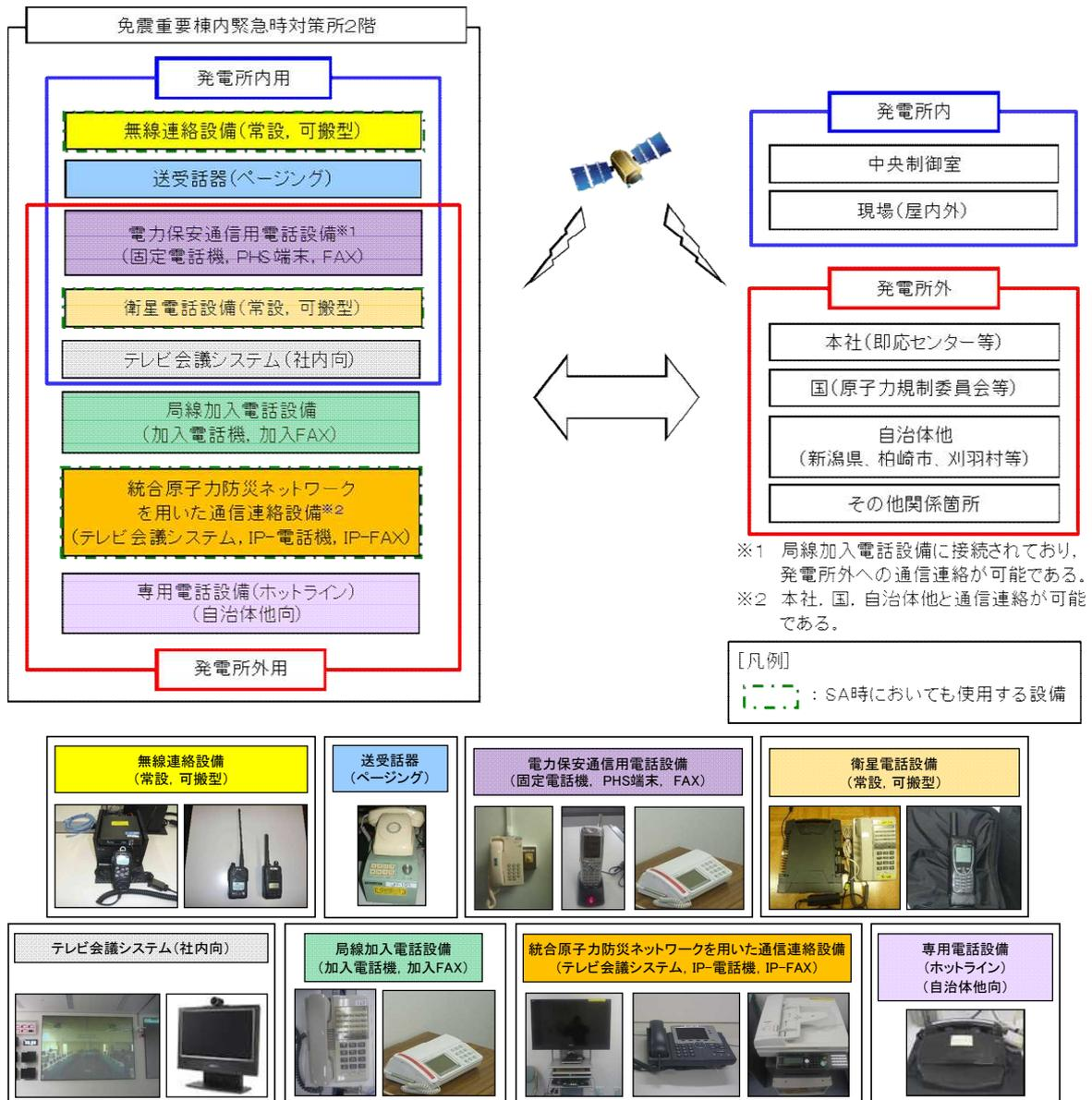
図 2.6-1 免震重要棟内緊急時対策所 2 階 通信連絡設備の概要
