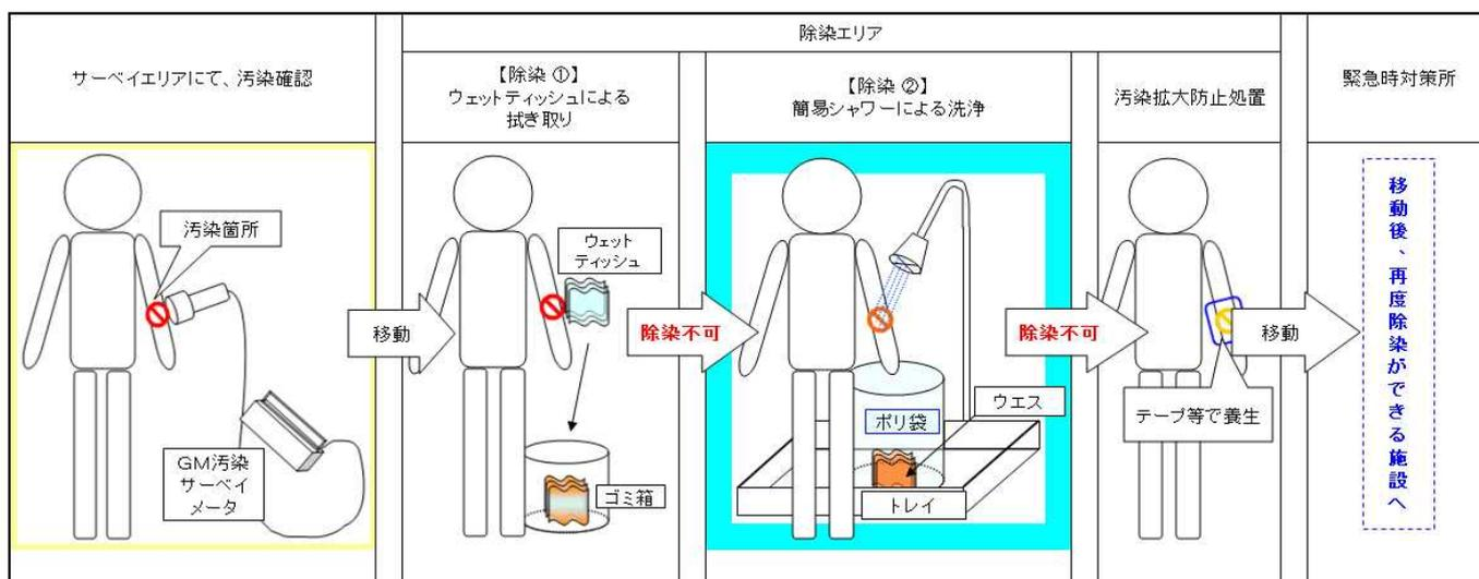
図 5.1-6 除染及び汚染水処理イメージ図
