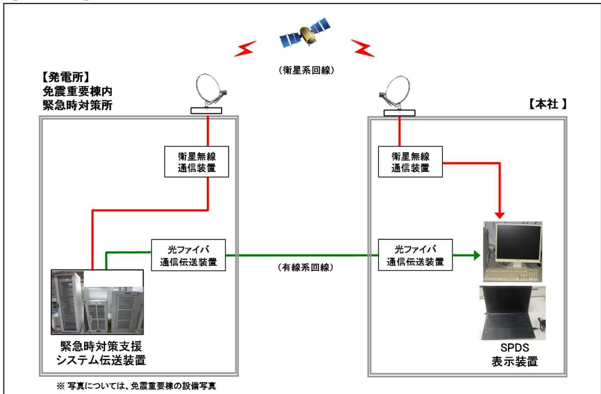
図 62-5-21 データ伝送設備 試験・検査構成
