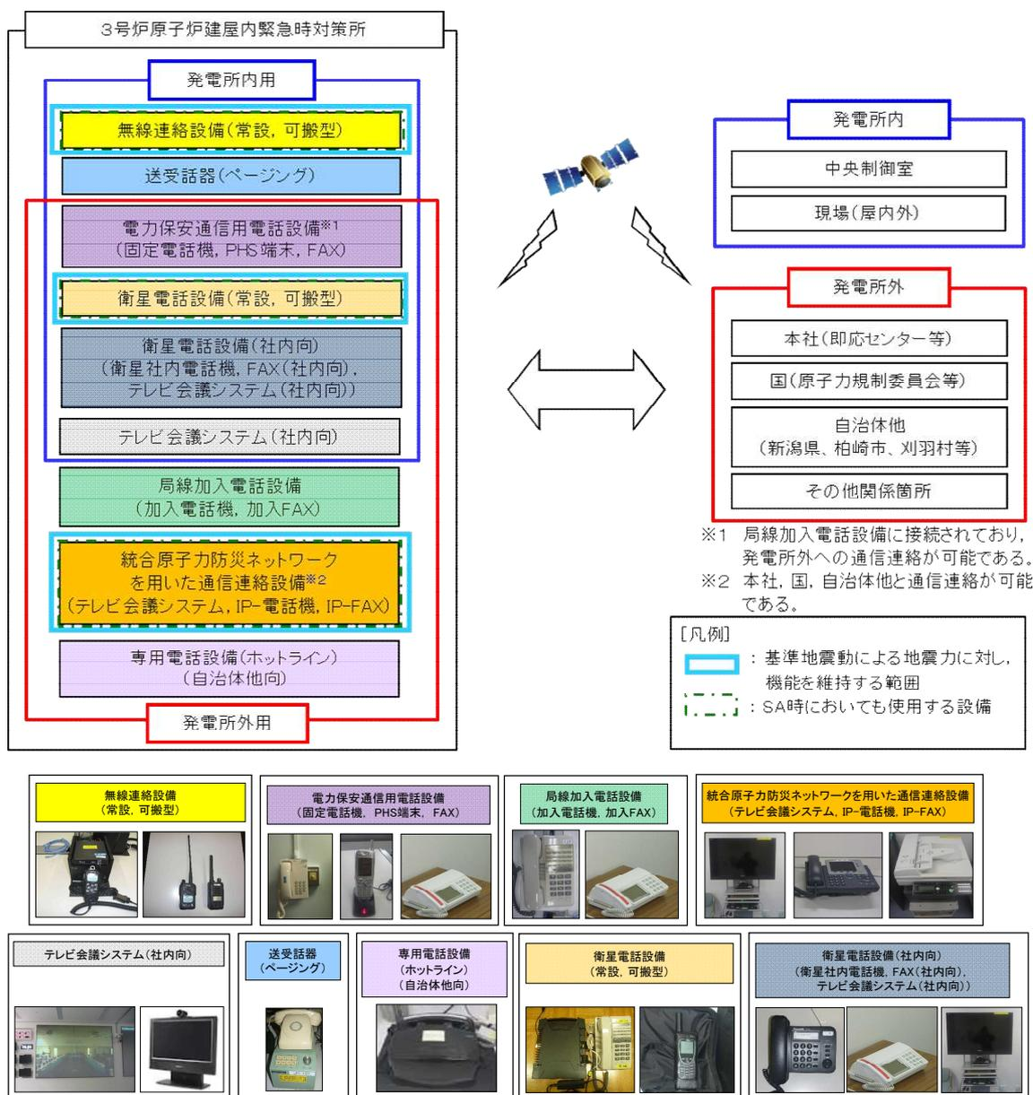
図 2.6-2 3号炉原子炉建屋内緊急時対策所 通信連絡設備の概要
