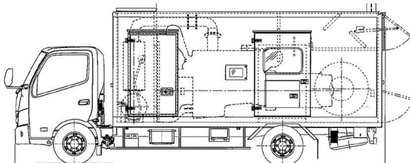
図 4-7 3号炉原子炉建屋内緊急時対策所用常設代替交流電源設備 外観図
