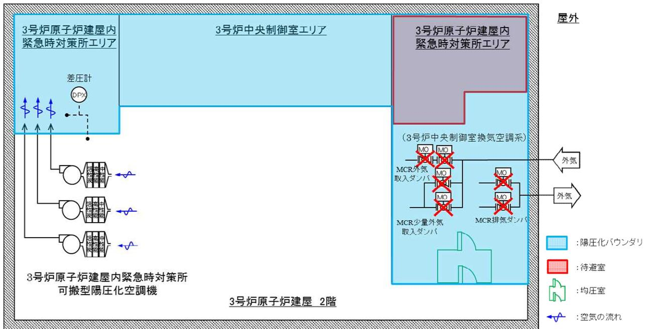
図 2.4-9 3号炉原子炉建屋内緊急時対策所 換気設備の系統概略図
