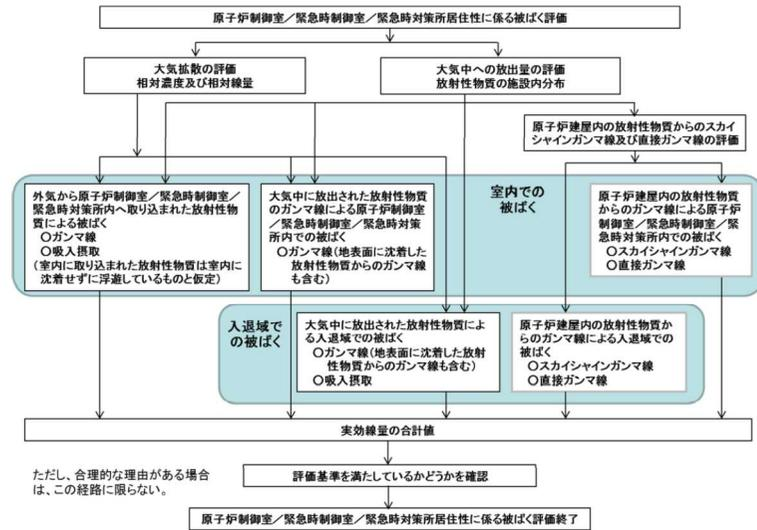
図3 原子炉制御室/緊急時制御室/緊急時対策所の居住性に係る
