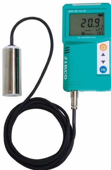
図 61-5-13 酸素濃度計の概略図
