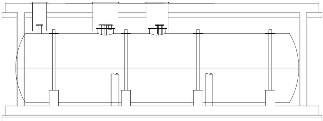
図 4-4 免震重要棟緊急時対策所用ガスタービン発電機用地下貯油タンク 概略図
