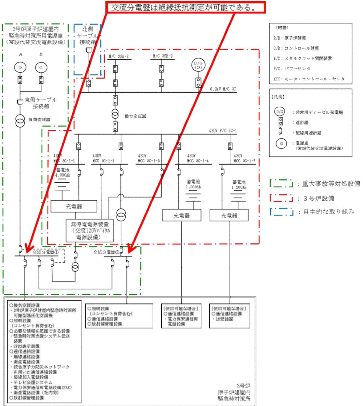
図 61-5-9 交流分電盤試験系統図
