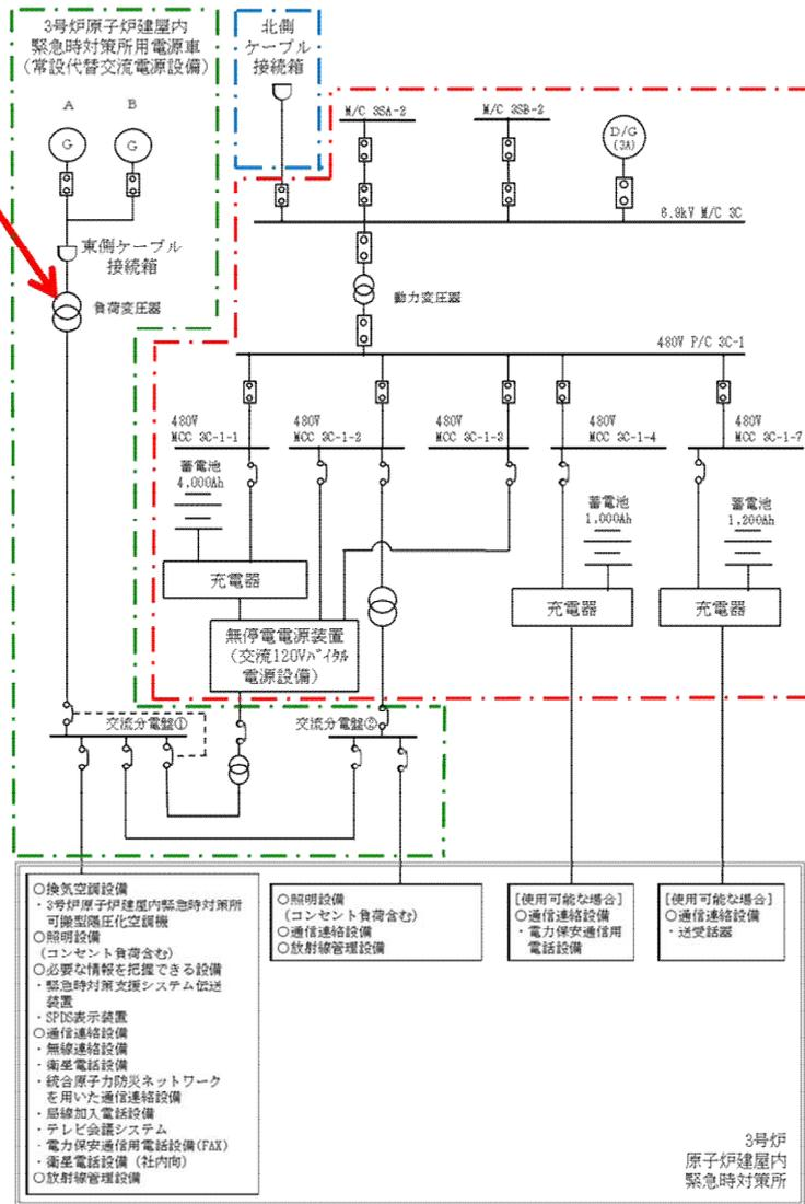
図 61-5-8 負荷変圧器 試験系統図
