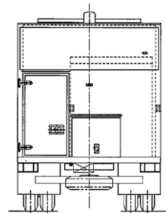
図 61-5-5 3号炉原子炉建屋内緊急時対策所用電源車 構造図
