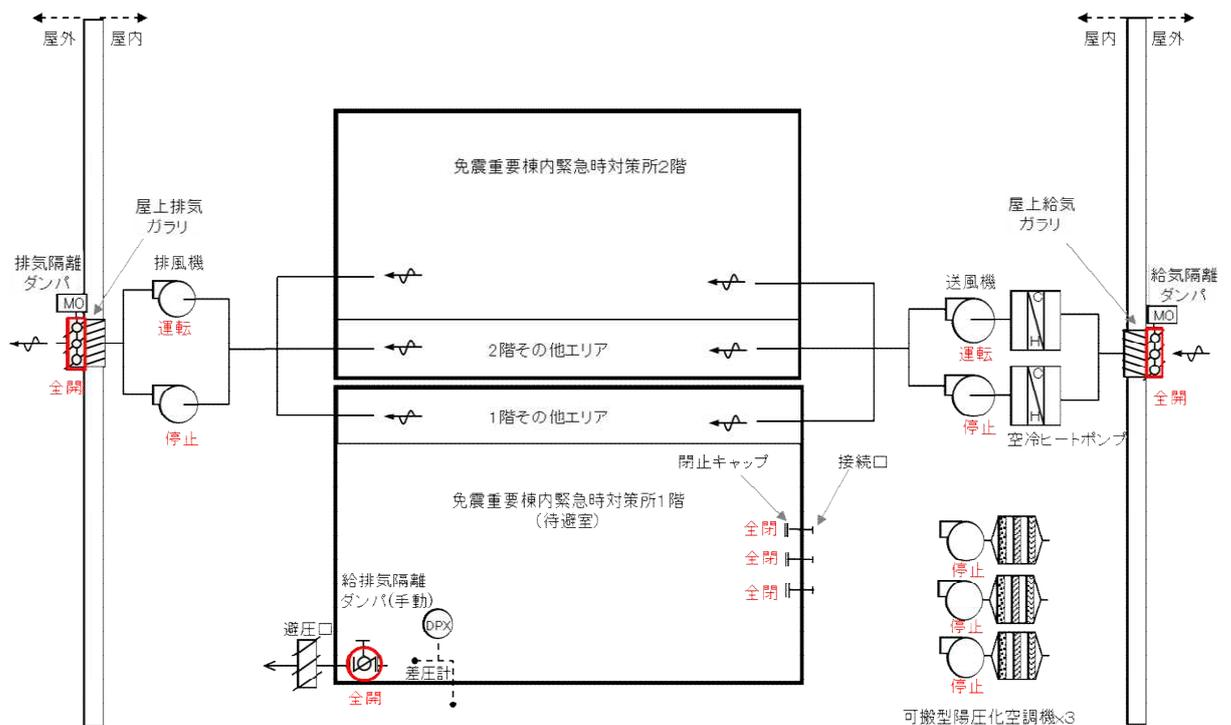
図 2.4-1 免震重要棟内緊急時対策所 2階 換気空調系系統図
