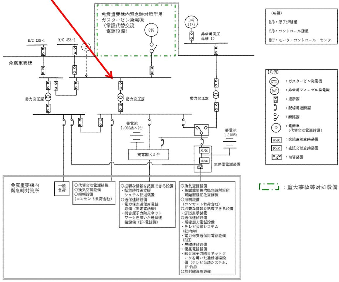
図 61-5-4 免震重要棟内緊急時対策所用ガスタービン発電機用受電盤試験系統図
