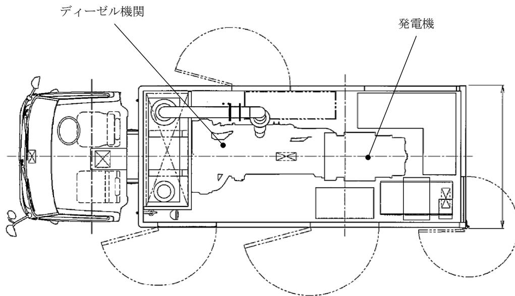
電源車の各部品は分解点検が可能な構造とする。
