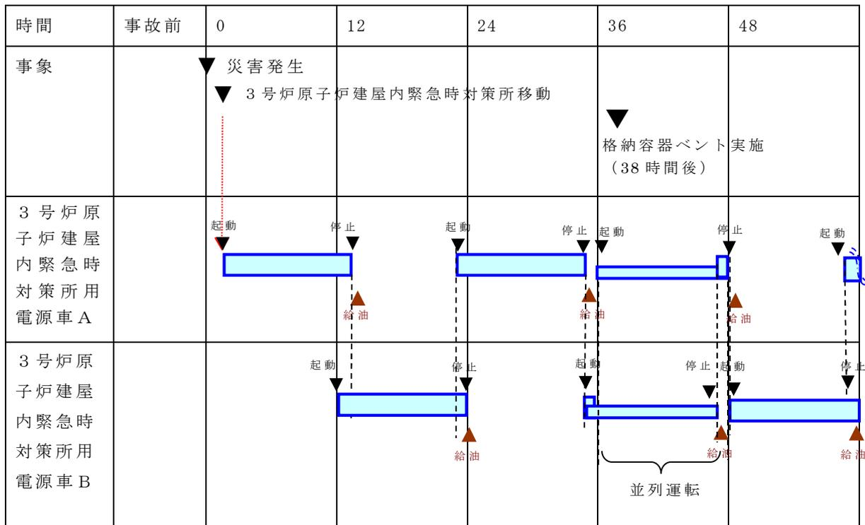
図 2.2-8 3 号炉原子炉建屋内緊急時対策所用電源車の給油時間
