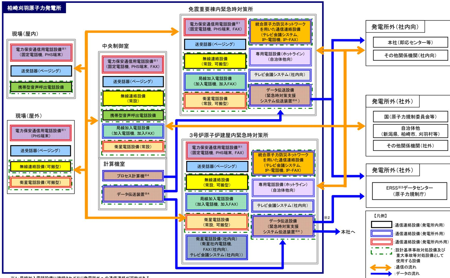
図 62-4-1 通信連絡設備の概要
