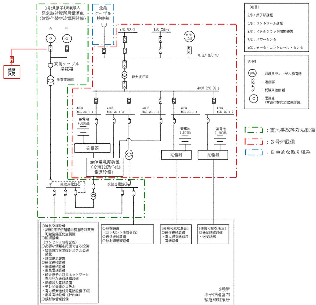
図 61-5-7 3号炉原子炉建屋内緊急時対策所用 電源車 試験系統図 (模擬負荷による電源車の出力性能確認)
