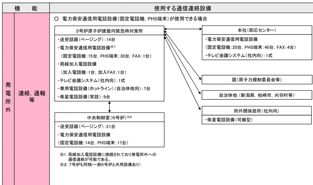
図62-6-4 機能毎に必要な通信連絡設備（発電所外）（1 / 2）
