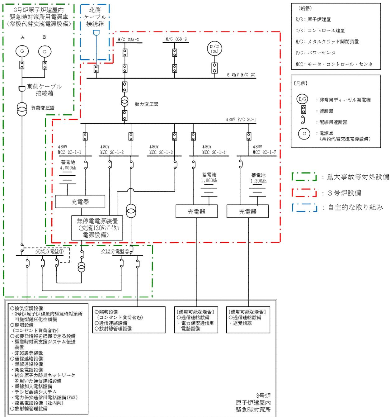
図 2.2-6 3号炉原子炉建屋内緊急時対策所 電源構成
