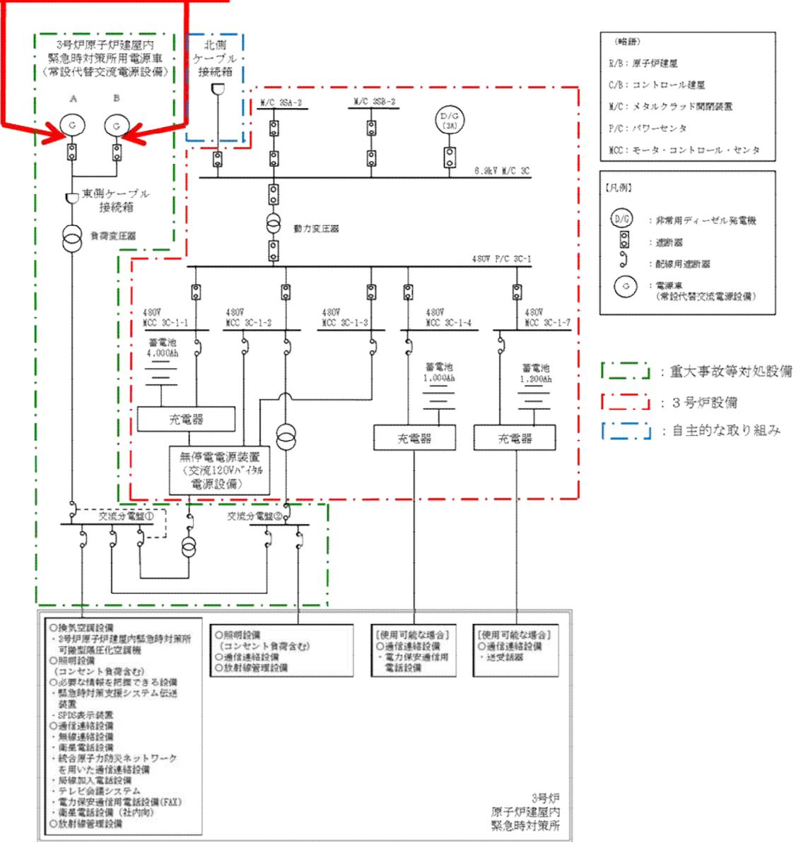
図 61-5-6 3号炉原子炉建屋内緊急時対策所用電源車ケーブル試験系統図
