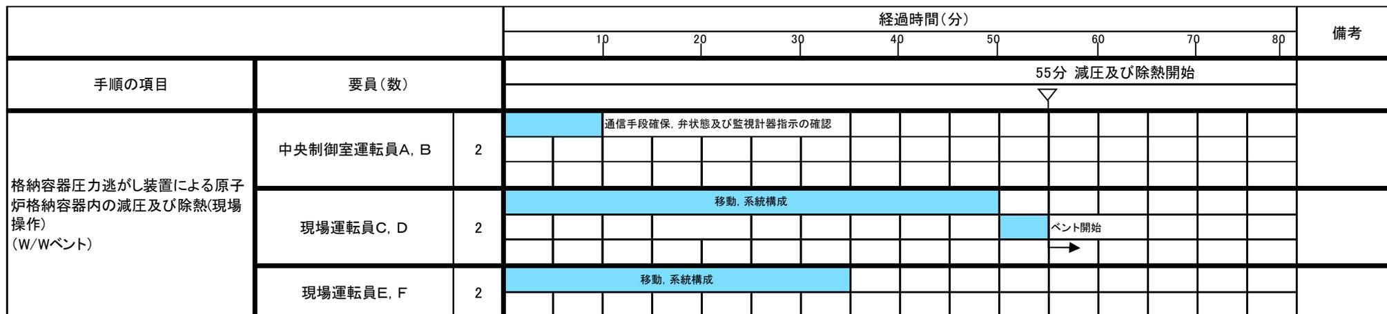
図 1.5.32 格納容器圧力逃がし装置による原子炉格納容器内の減圧及び除熱 (W/W ベント) タイムチャート (現場操作)
