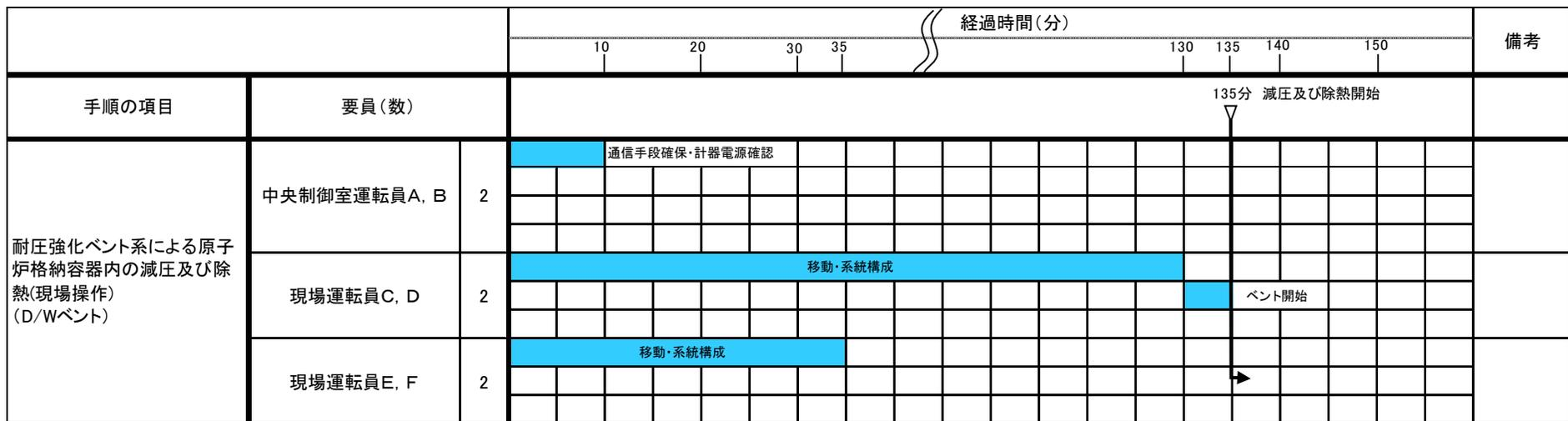
図 1.5.39 耐圧強化ベント系による原子炉格納容器内の減圧及び除熱(D/Wベント) タイムチャート
