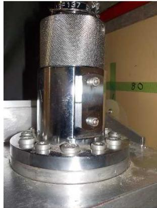
ユニハンドラー弁のリンク機構
