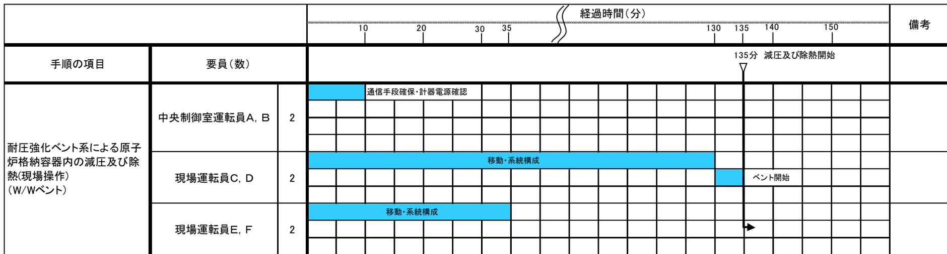
図 1.5.38 耐圧強化ベント系による原子炉格納容器内の減圧及び除熱(W/Wベント) タイムチャート
