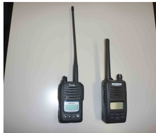
無線連絡設備（可搬型）
