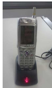
電力保安通信用電話設備 (PHS 端末)
