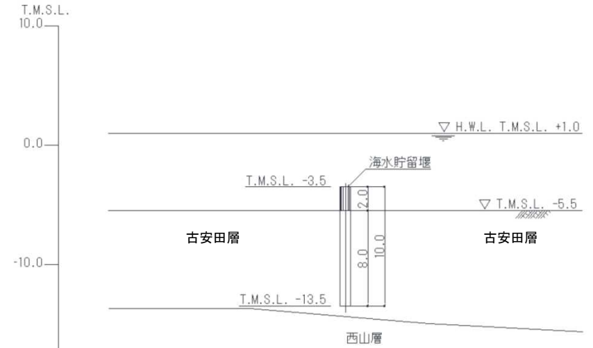
6号炉海水貯留堰断面図 (単位: m)
