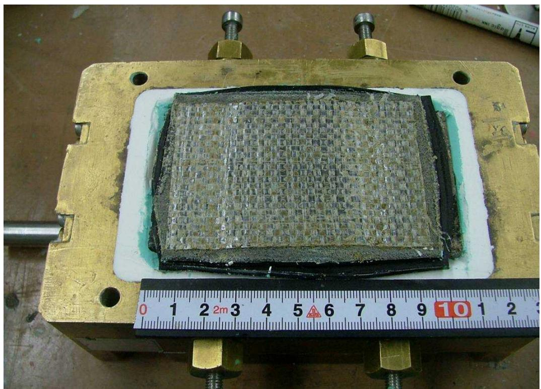
写真 3.3.15 繰返し載荷試験後の供試体状況 ケース 1-8 (保護層表面)
