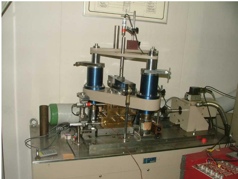
写真 3.2.1 一面せん断試験装置全景
