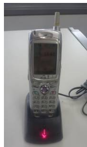
電力保安通信用電話設備 (PHS 端末)
