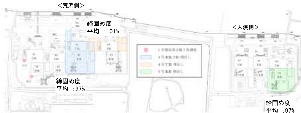
埋戻土の締固め度 (建屋周辺)
