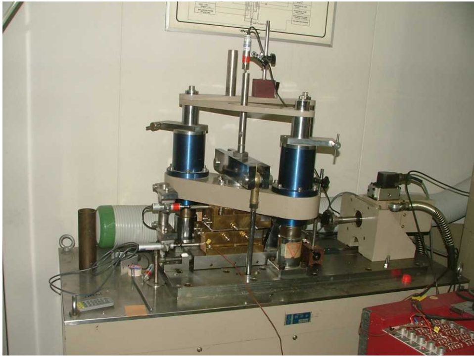
写真 3.2.1 一面せん断試験装置全景
