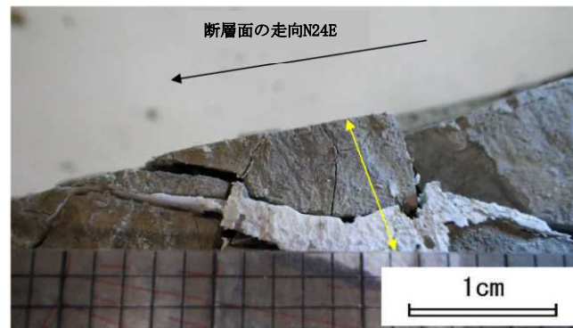
低角度断層②下面の条線 (黄色矢印方向)
