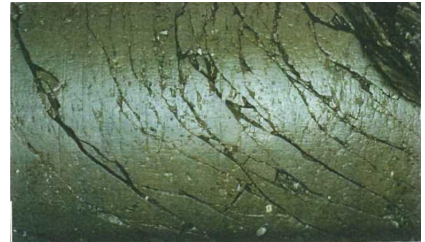
面が開離するへき開部 (ボーリングコア)
