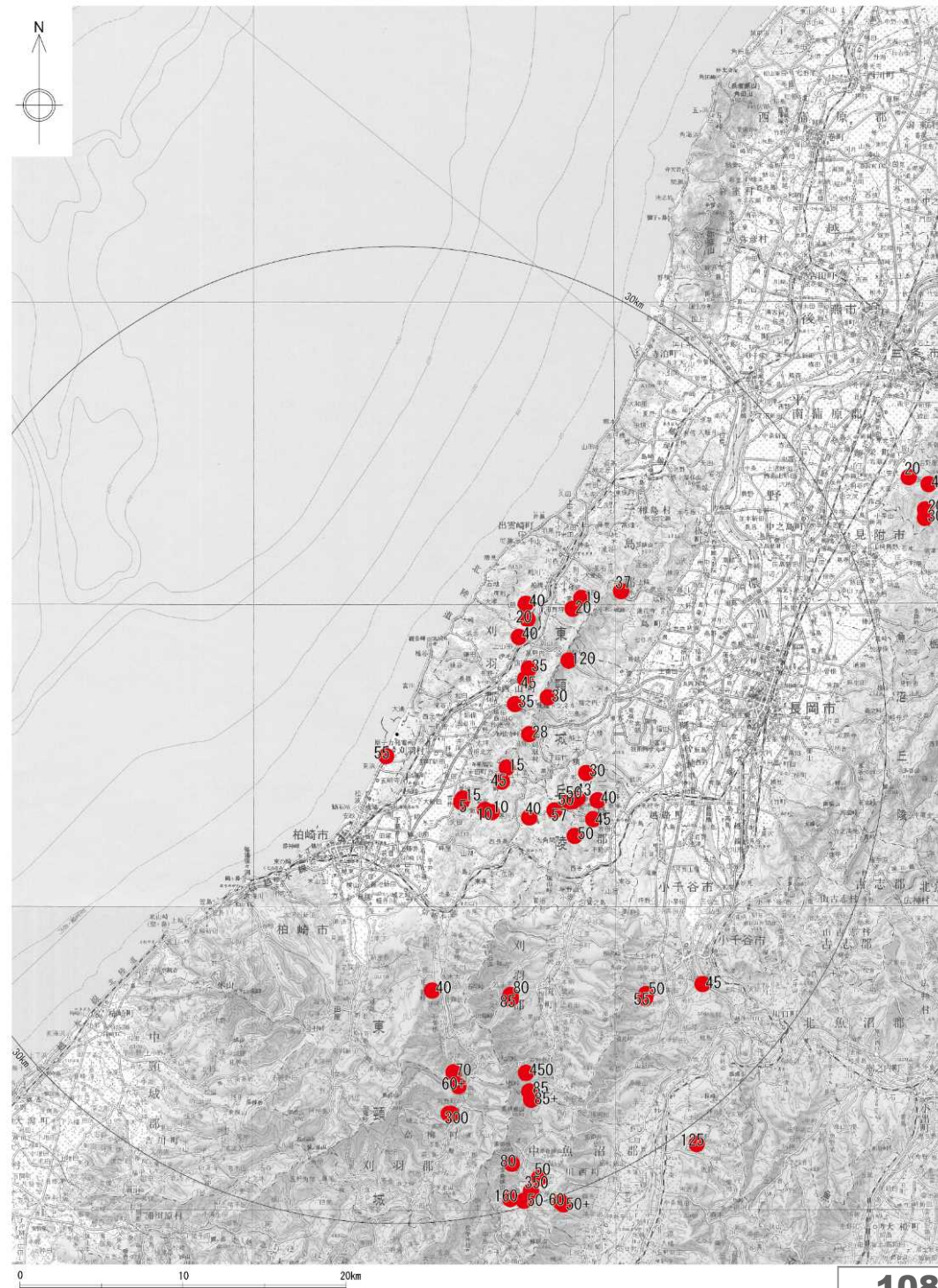
出雲崎テフラの分布図 (図中の数値は層厚 (単位: cm) を表す)
