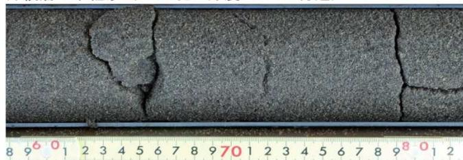
・重鉱物（有色鉱物、不透明鉱物）を多く含む。有色鉱物は斜方輝石を多く含む。不透明鉱物は磁性鉱物を多く含む。
