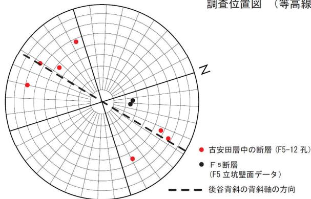
古安田層中の断層の走向傾斜
