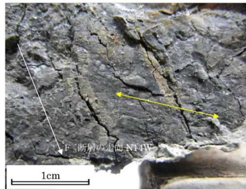
F<sub>3</sub>断層②の条線 (黄色矢印方向)
