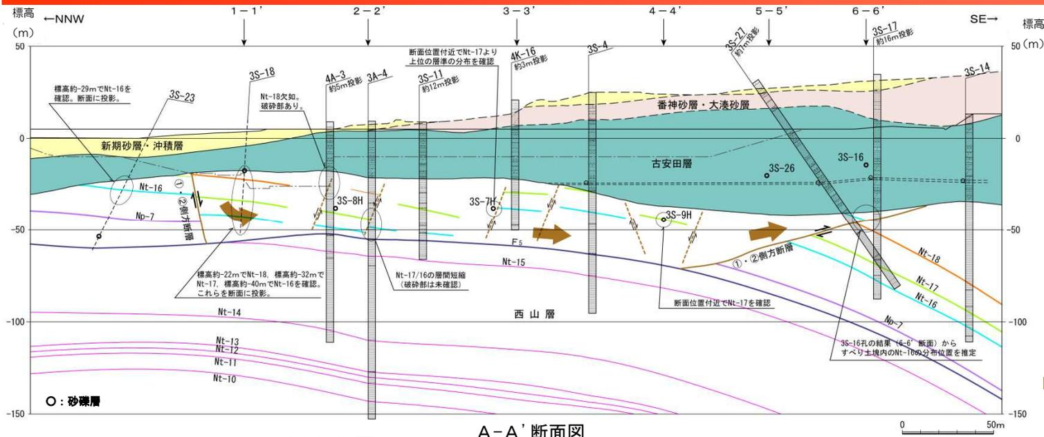
➡ ①・②断層すべり土塊の大局的な移動方向
