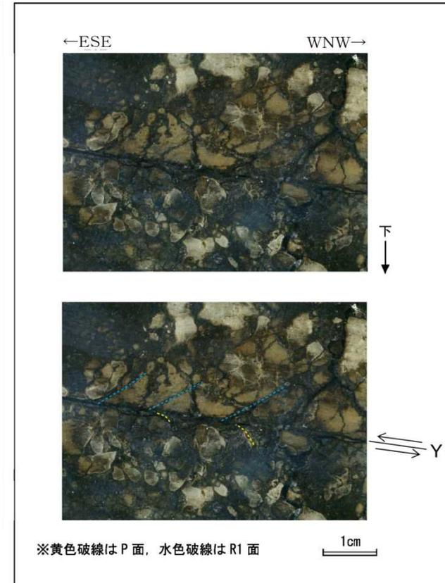
研磨片試料観察結果(赤枠内の拡大)
