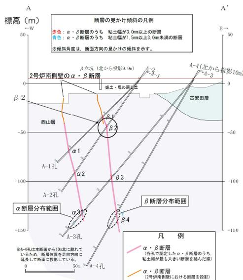
1・2号炉間地質断面図 (A-A' 断面)
