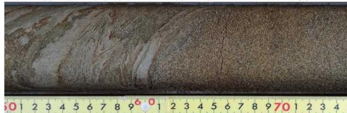
・重鉱物を多く含む。重鉱物は有色鉱物が少なく、不透明鉱物が多い。不透明鉱物は磁性鉱物を含む。
