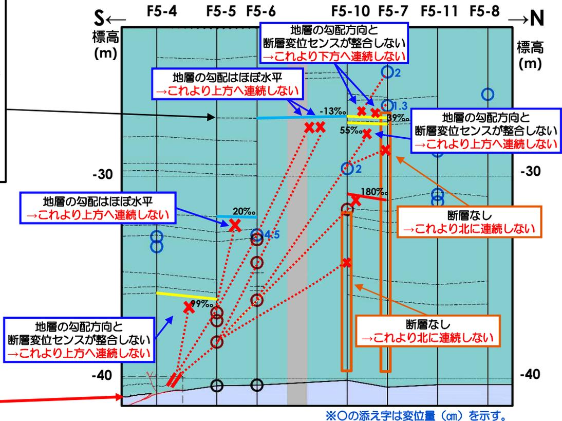
F5立坑近傍の地質断面図（拡大）
