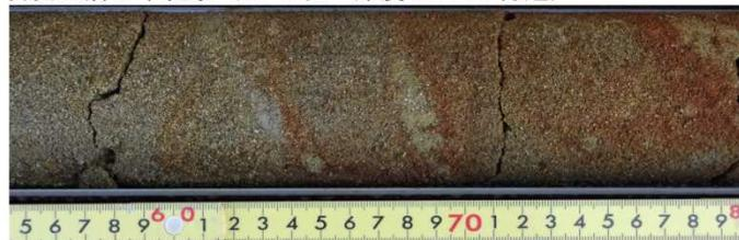
・重鉱物を多く含む。重鉱物は有色鉱物、不透明鉱物ともに多く含む。有色鉱物は、斜方輝石が多い。不透明鉱物は磁性鉱物を含む。
