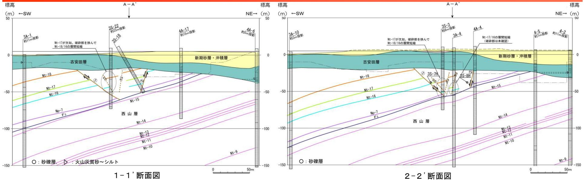
注) 鍵層の走向・傾斜は、地すべり土塊の外側の構造と平行と仮定して表記。推定断層は、鍵層の分布に不連続や鍵層間の層厚の短縮が見られる箇所に高角度正断層として表記。(他の断面図も同様)
