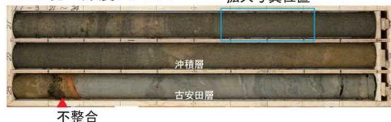
沖積層：中粒砂 (L1-3 孔 深度 21.70m 付近)
