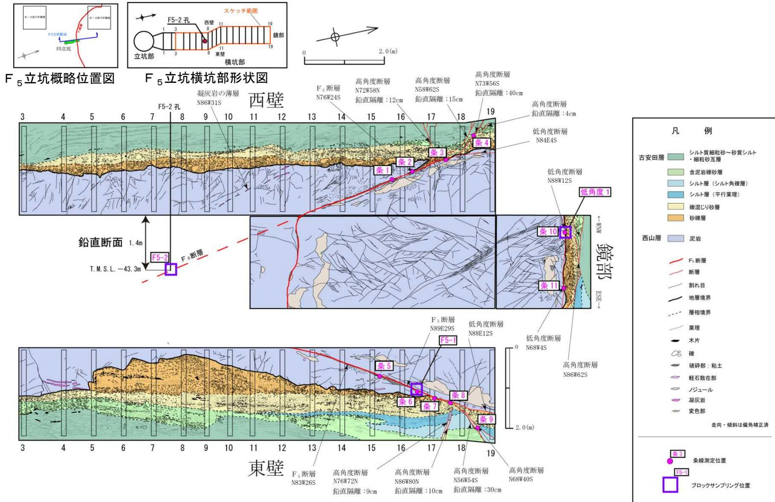
F<sub>5</sub>断層・低角度断層・高角度断層の条線測定及び研磨片・薄片作製試料採取位置
