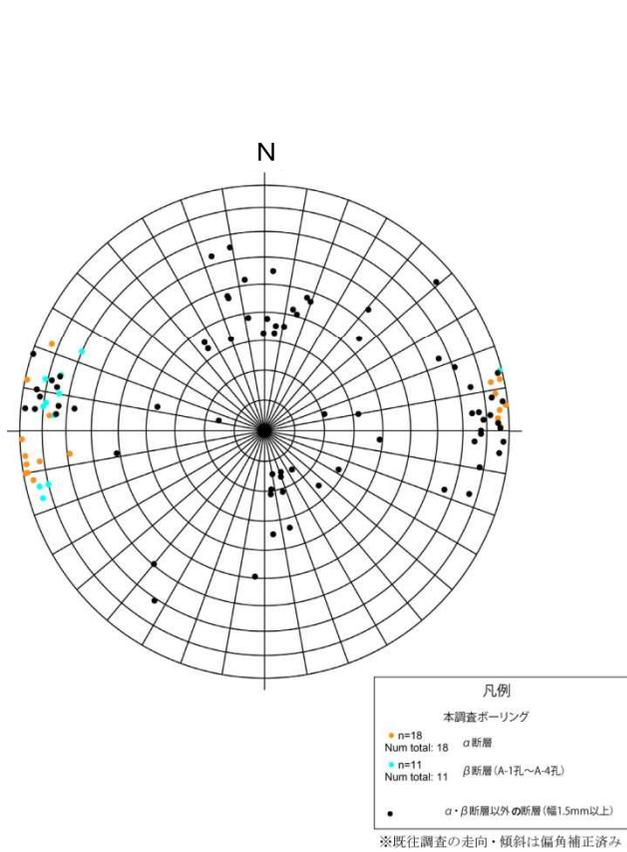
ボーリング孔で確認された断層の走向・傾斜
