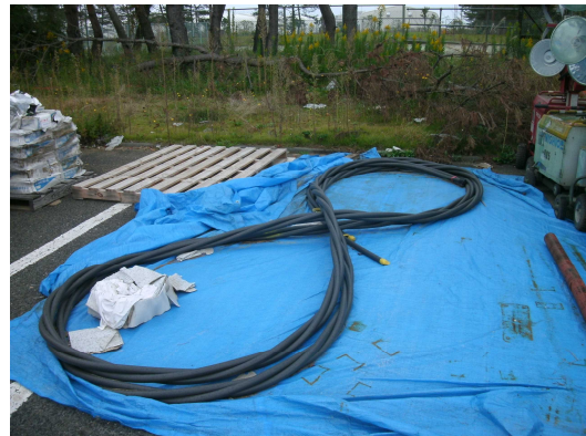
写真のケーブルは約 15m で重さは約 90kg。1,2 号の電源復旧はこの 10 倍以上の長さを使用。(後日撮影)
