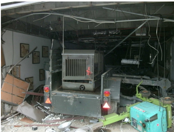
自衛隊低压電源車。トレーラーに小型発電機が積載されたもので、移動には牽引が必要（後日撮影）
