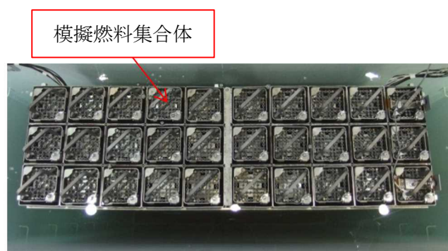
(2) 供試体の水槽内設置状況
